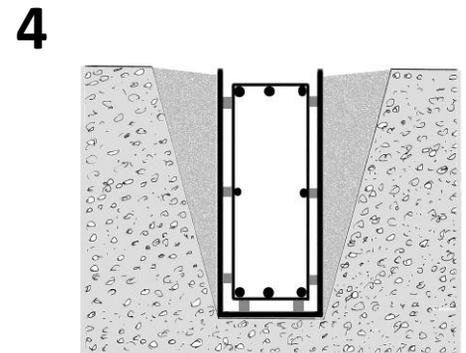
Angeklappte Seitenteile anfüllen und den Beton einbringen
