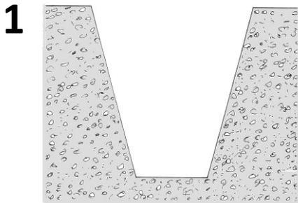
Das Ausheben des Fundamentgrabens sollte möglichst nahe an den Fundamentmaßen erfolgen.
