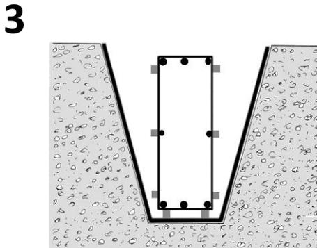
Einbauen der Bewehrung und Sicherung mit Abstandhaltern
