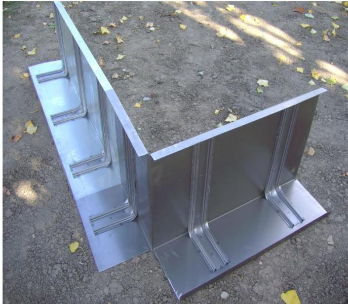
Die Eckausbildung ist bauseits durch Einschneiden des Bleches mit Blechscherer oder Winkelschleifer einfach zu fertigen. Gegen seitliches Verschieben sind die **Randfix**-Elemente durch Erdnägeln oder lange Drahtstifte zu sichern.
