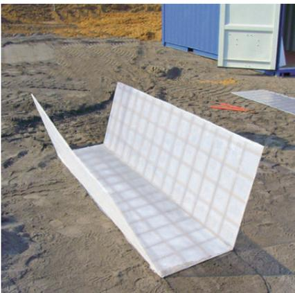
Die Schalungssysteme ecofix und ecofixtherm bestehen aus einem Gitterwerk aus Stabstahl im Raster von 7,5 x 15 cm (Standard) oder 10 x 15 cm, das von einer umweltfreundlichen Schrumpffolie aus Polyethylen fest umhüllt ist. Bei dem System ecofixtherm ist zusätzlich eine Dämmschicht von außen auf die Schrumpffolie aufgebracht bzw. aufgeklebt. Die plan angelieferten Elemente können dank des Scharniers/Gelenks auf der Baustelle in die gewünschte Form aufgeklappt und zum Einsatz gebracht werden.
